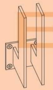
Fijación tipo bastón a muro
